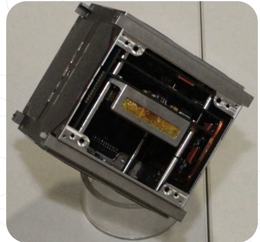
CubeSat – Würfel mit 10 cm Kantenlänge
